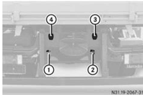
Выводы для подключения прицепа (пример)
