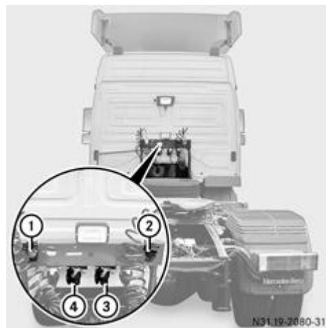
Выводы для подключения полуприцепа (пример)
