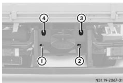
Выводы для подключения прицепа (пример)
