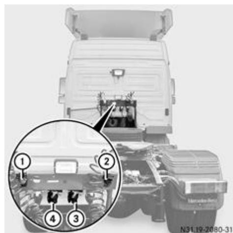
Выводы для подключения полуприцепа (пример)
