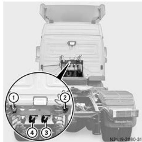
Выводы для подключения полуприцепа (пример)
