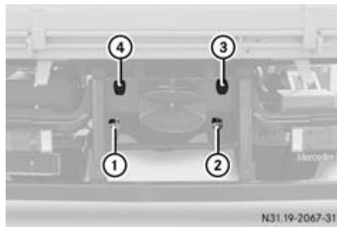
Выводы для подключения прицепа (пример)
